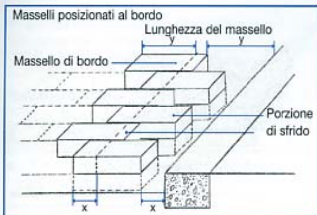
Fig. 27 - Marcatura dei masselli per il taglio
