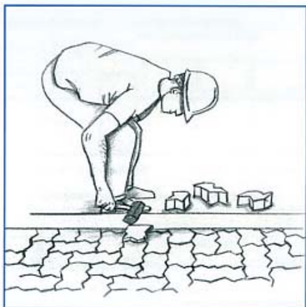
Fig. 29 - Sistemazione dei masselli tagliati negli appositi spazi
